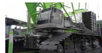
Cầu xích 800 tấn - SCC8800A Chain crane 800 tones - SCC8800A
