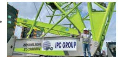
Cầu xích 800 tấn - ZC9800 Chain crane 800 tones - ZC9800
