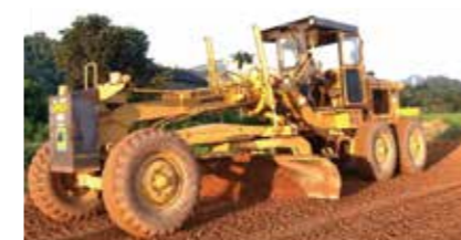
Máy san gạt thi công đường Grader for road construction
