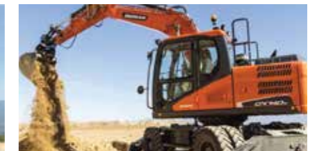
Máy xúc bánh lốp dung tích gầu 0,7m 3 Wheel loader with shovel capacity of 0.7m 3
