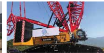
Cần trục bánh xích 800 tấn Main Crawler crane 800 tones
